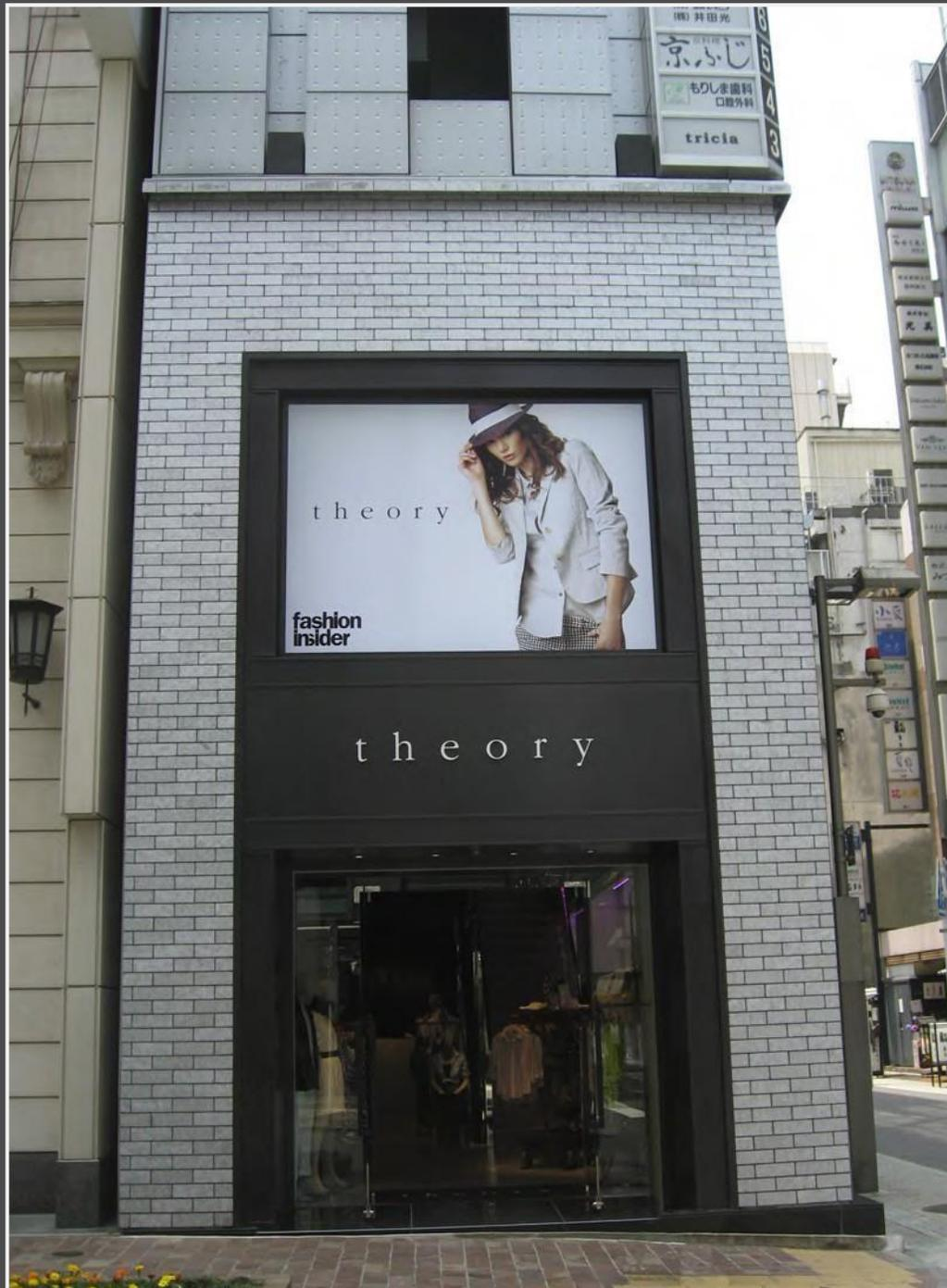
ALUSION™ Theory, Japan - Revestimiento exterior en configuración de ladrillo, ALFG-12.7-SM, Células Pequeñas, Natural. Espesor: 12.7 mm (0.5").
