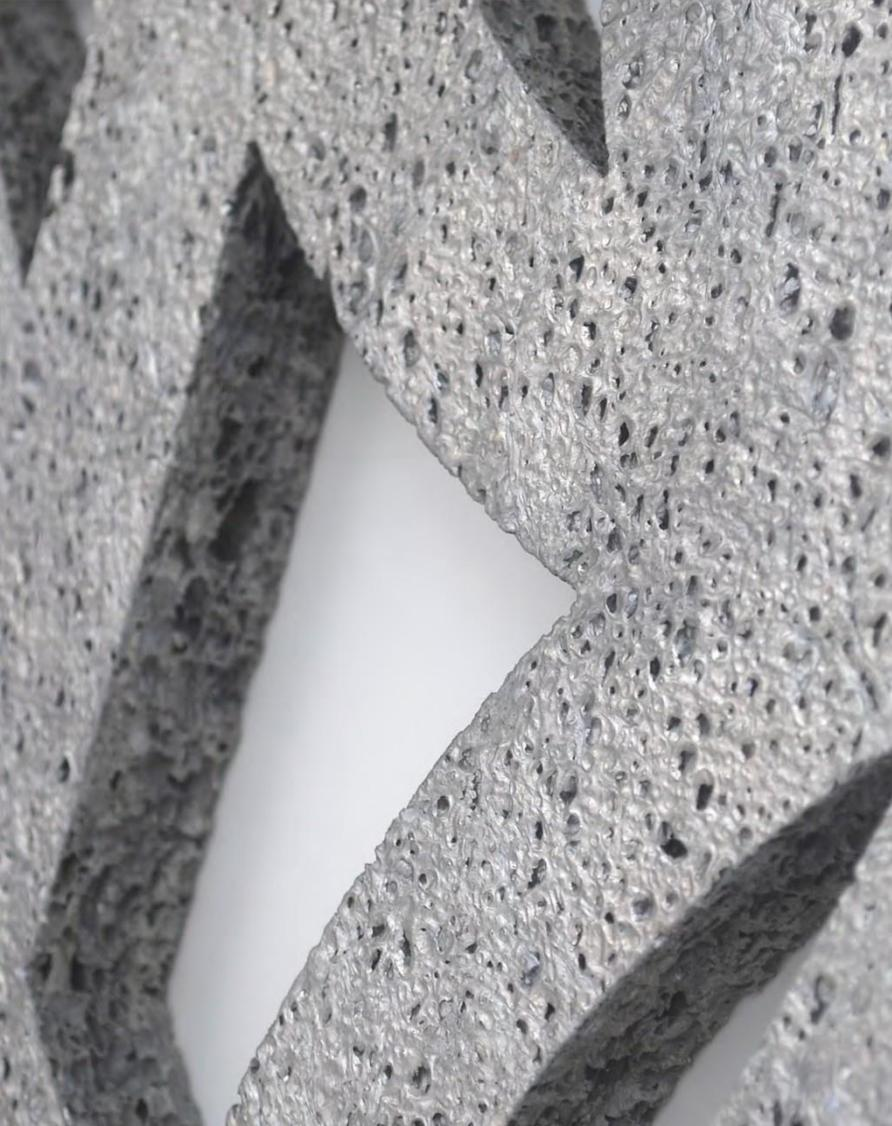
Hay tres tipos de versiones básicas de ALUSION™ espuma de aluminio estabilizado:
